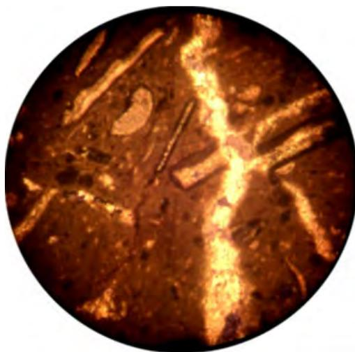
Рисунок 3 – Известняк органогенно-обломочный, Порода не пористая, трещиноватая, трещины заполнены темно-бурого до черного цвета и кальцитом. Месторождение Ходжи, скв. №3, инт. 2155-2158 м
