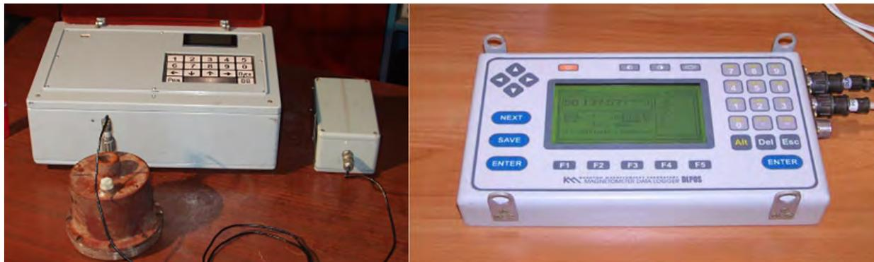
Рисунок 2 – Магнитометры МВ-07 (слева) и ММПОС-1 (справа)
