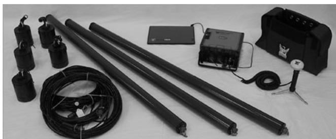
Рисунок 1 – Полный комплект оборудования МТЗ Phoenix MTU-5 с индукционными датчиками МТС-50
