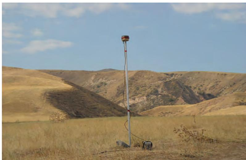
Рисунок 3 – Измерение магнитного поля на передвижном пункте наблюдений
