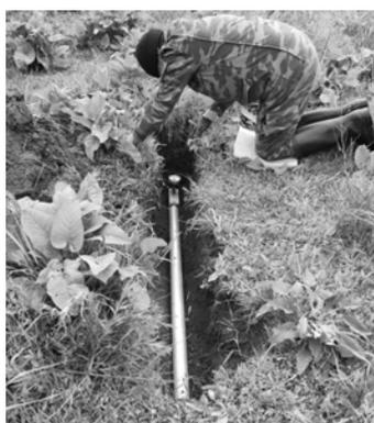
Рисунок 3 – Установка буссоли и шаблона индукционного датчика МТС-50 в неглубоких траншеях (фото © Научная станция РАН в г. Бишкек)
