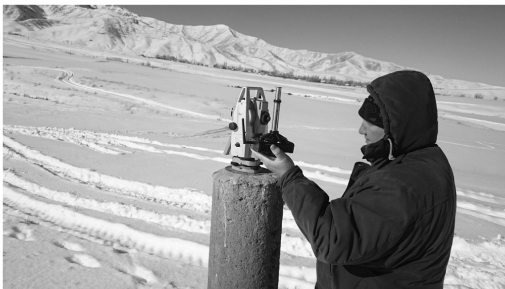
Рисунок 10 – Полевые линейно-угловые измерения на площадке Kentor.
