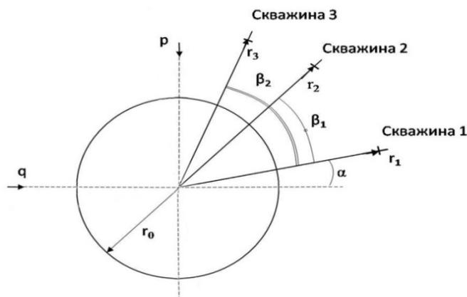
Рисунок 1 – Схема измерительного гидроразрыва с тремя произвольно ориентированными скважинами.
