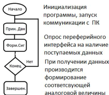
Рисунок 6 – Алгоритм формирования аналогового сигнала.
