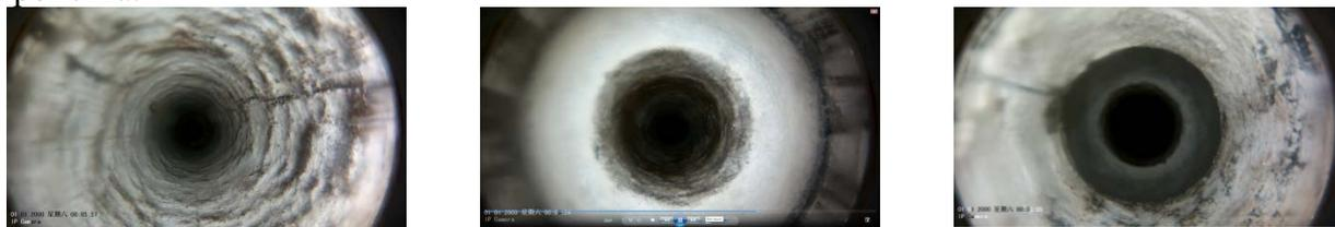
Рисунок 7 – Вид измерительной скважины вблизи забоя (слева), в области нарезанной щели (в середине), на удалении от щели (справа).
