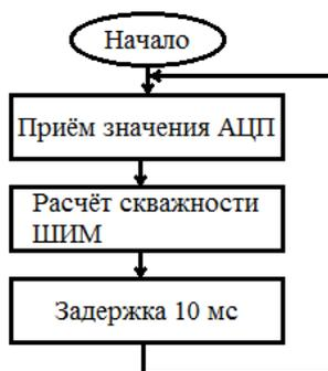
Рисунок 4 – Блок – схема программы.
