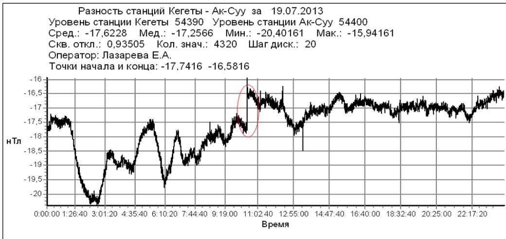
Рис.6. Магнитограмма со ступенчатым искажением
