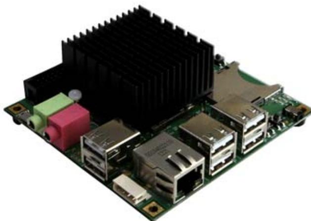
Рис. 2. Микрокомпьютер ODROID-X2.
