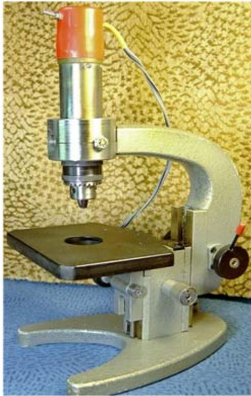
Рис. 1. Сверлильный станок на базе микроскопа.
