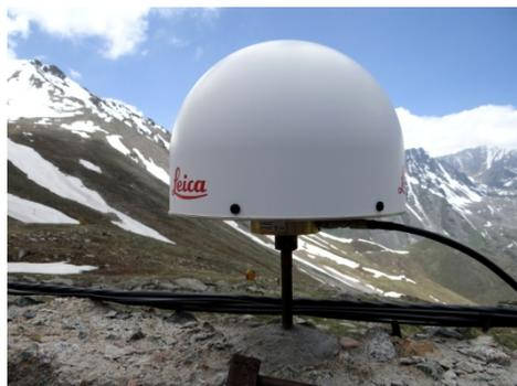
На примере GPS-пункта «Тургень» рассмотрена динамика пространственных смещений по широте, долготе и высоте. Обработка результатов измерений проводилась по стандартной методике расчетов псевдорасстояний и фазовых измерений для каждого дня наблюдений программным пакетом GAMIT/GLOBK [1]. Дискретность взятия отсчетов составляла 30 сек. На первом этапе обработки GPS-данных, на основе дифференциальных фазовых и кодовых
